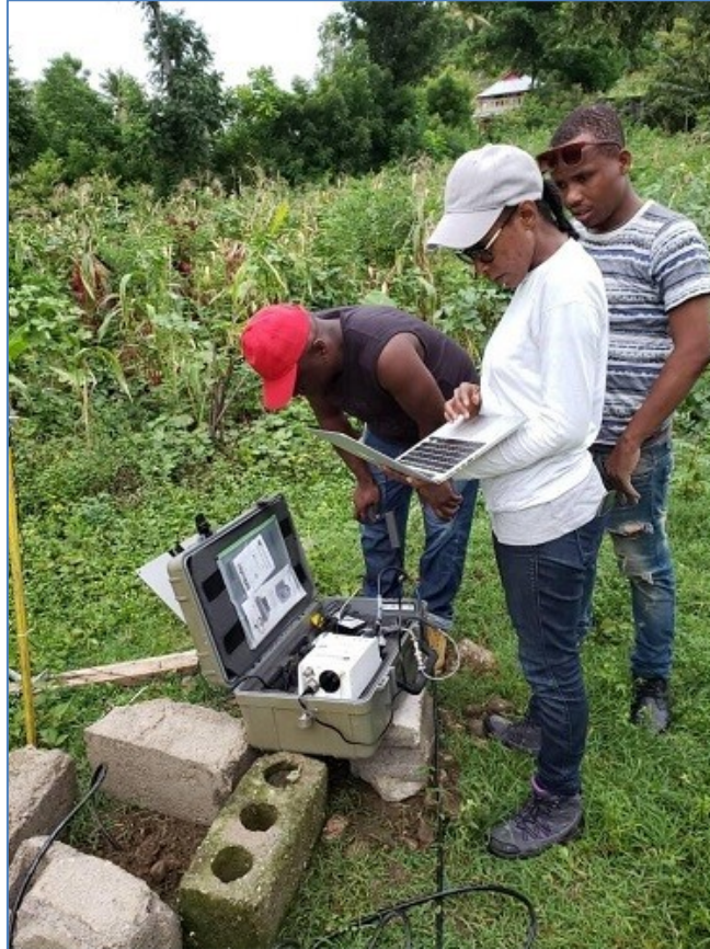
Crédits : Sadrac St Fleur - Étudiants/es du master géosciences-géorisques (UEH) sur le terrain installant des sismomètres dans la semaine qui a suivi le séisme du 14 août 2021
